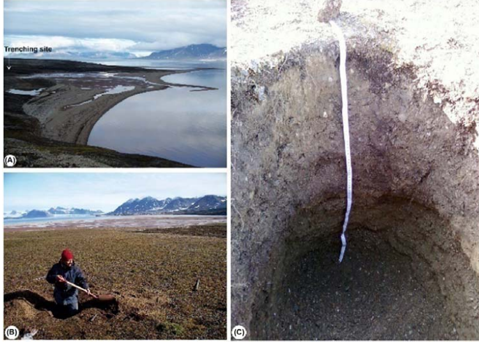
चित्र: ने-आलेसुंड स्वालबार्ड, आर्कटिक में नमूनाकरण: (A) कोल्हामना लैगून और ट्रेंच का स्थान। (बी) पृष्ठभूमि में कोल्हामना लैगून और कोंग्सफिओर्ड के साथ ट्रेंचिंग साइट। (सी) उपसतह नमूने के लिए खोदी गई खाई।
